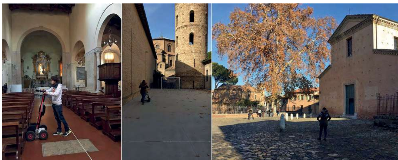
7. Indagini georadar presso la Chiesa di Santa Maria Maggiore (foto degli Autori)
