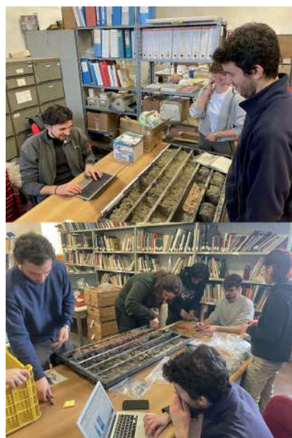
11. Attività di campionamento delle carote presso il Centro Operativo di Ravenna (foto degli Autori)
