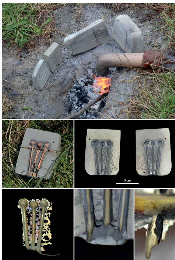
Fig. 15. Operazioni di colatura e semilavorati ottenuti.
